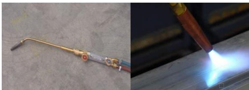
图 6-2 焊炬和加热方式
