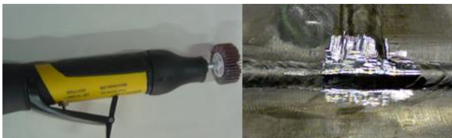
图 5-13 砂纸环的工作示意
