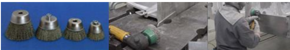
图 5-3 角向砂轮配合杯型刷的工作示意
