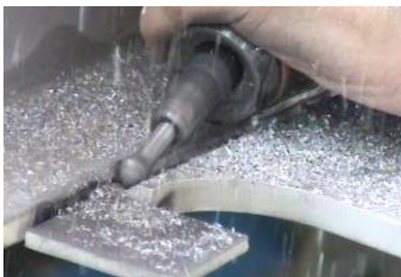
图 5-9 球型锉头工作示意
