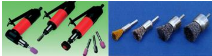
图 5-6 指状砂轮配指状刷示意
