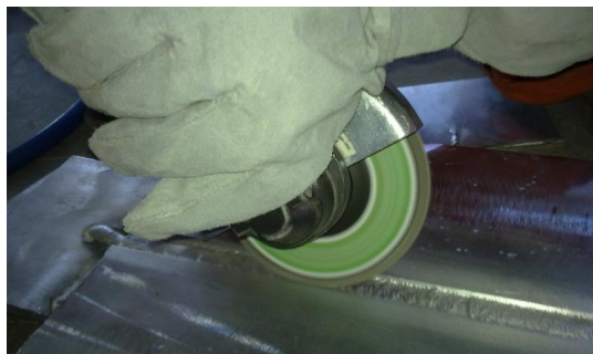
图 5-14 千页片修磨焊接面的工作示意
