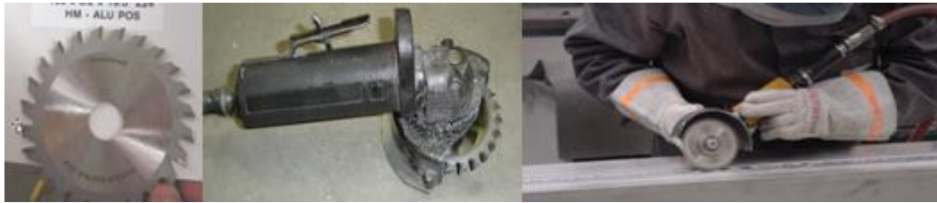
图 5-8 片刀和角向砂轮配合使用工作示意
