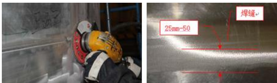
图 5-15 面砂轮的工作示意
