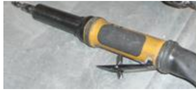
图 5-11 直柄砂轮配合旋转锉工作示意
