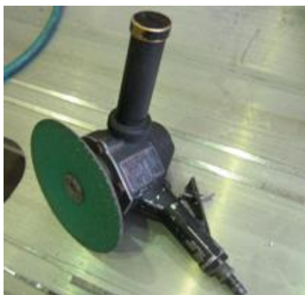
图 5-16 面砂轮配合面砂指工作示意
