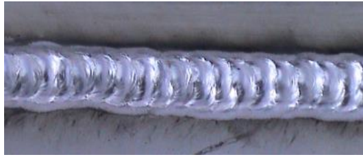
图 30-7 典型的不良焊缝例子
