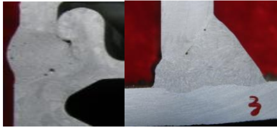
图 30-22 气孔和未熔合
