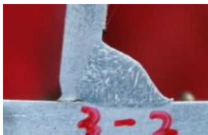
图 30-11 发生的咬边示意图
