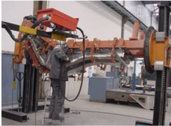
图26-5 H型头尾架焊接变位装置
