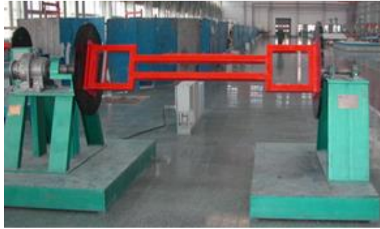
图26-2 电动一轴变位机示意
