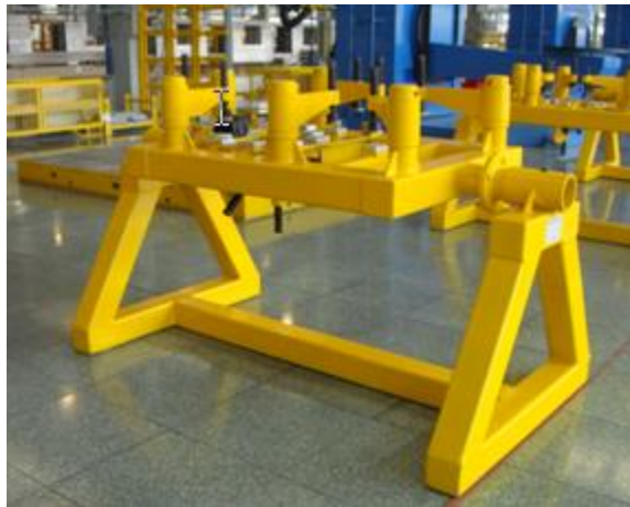
图 26-1 一轴手动变位机示意
