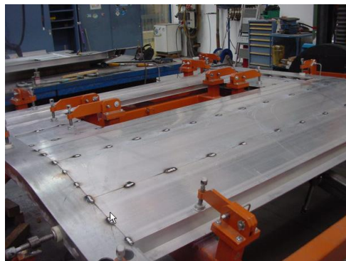
图 22-7 侧墙组对后示意图
