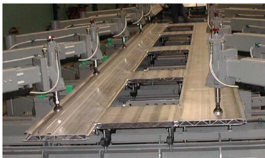
图 22-20 侧墙简易制造模式
