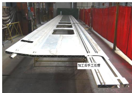
图 22-32 侧墙手工处理示意
