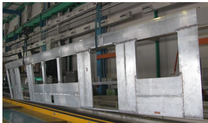
图 12-12 侧墙设计结构示意图
