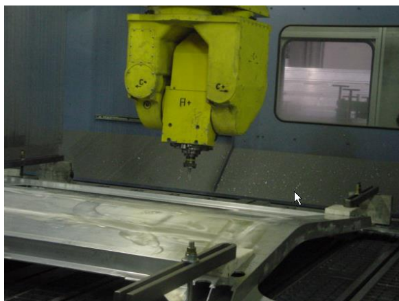
图 22-11 侧墙窗口加工
