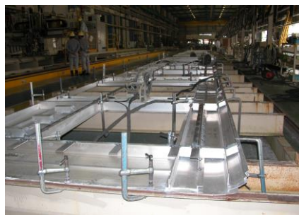
图 22-14 开式型材侧墙组对工艺过程示意图
