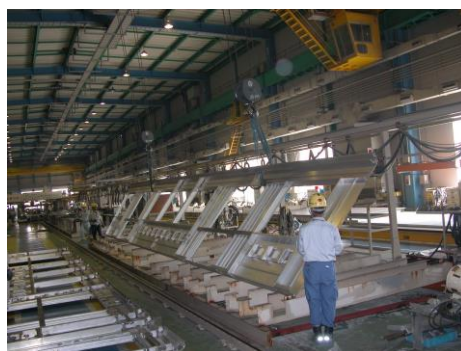
图 22-15 侧墙内侧焊接
