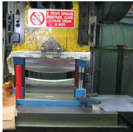
图 22-5 压弯成型示意
