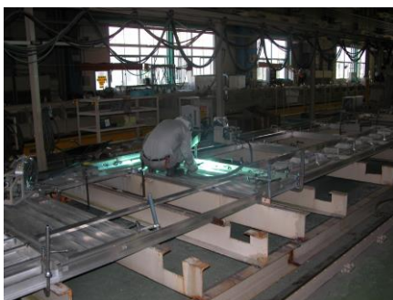
图 22-15 侧墙内侧焊接
