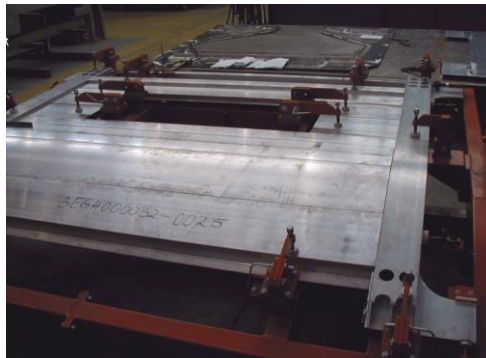
图 22-7 侧墙组对后示意图
