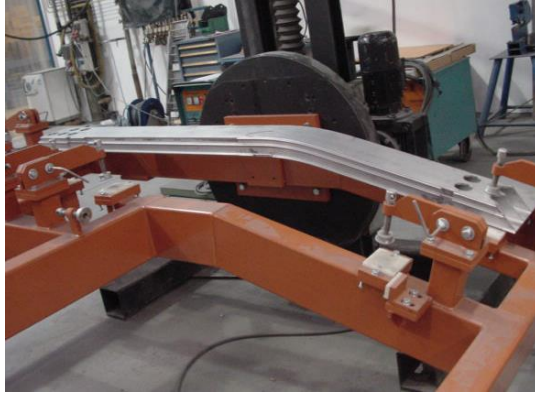
图 22-6 放入门柱示意图
