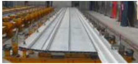
图 22-24 侧墙反侧焊接示意图
