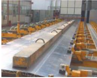
图 22-23 侧墙正侧焊接示意图
