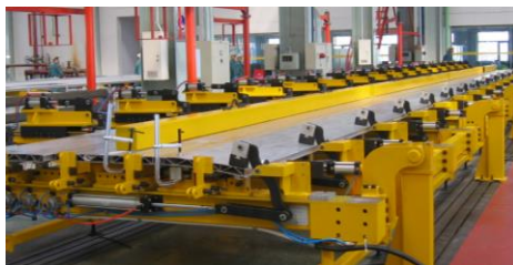
图 22-29 侧墙组焊示意图
