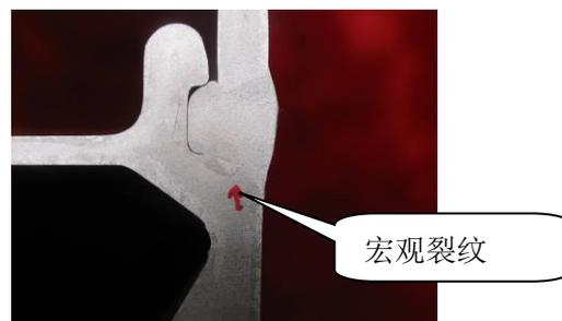
图 20-11 裂纹示意
