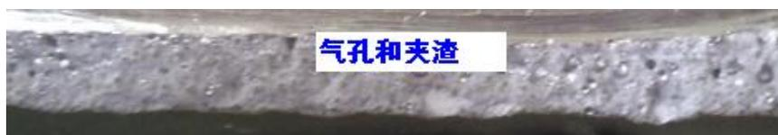
图 20-4 气孔和夹渣示意
