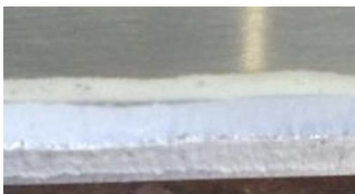
图 20-6 根部熔合良好示意
