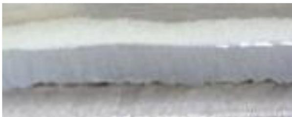
图 20-5 黑线显示根部未熔合示意
