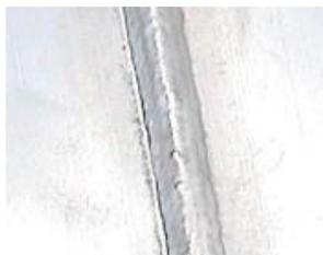
图 20-2 焊缝过高示意图
