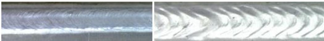
图 20-1 左侧是理想的焊缝外观（成型细腻），右侧是不理想焊缝（纹路太大）
