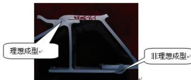
图 20-7 焊缝成型示意
