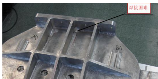
图 2-16 焊接困难位置示意
