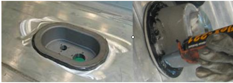
图 2-9 铝车体和铸件粘接示意
