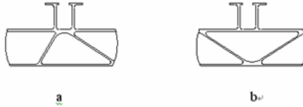
图 2-4 型材筋位置示意
