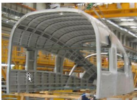
图 16-11 车头结构示意图
