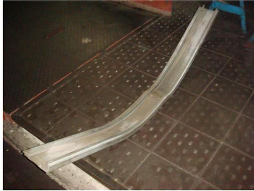
图 16-6 压力成型后的零件
