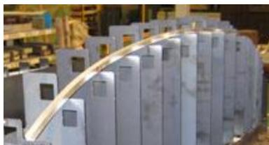
图 16-14 调型后样板检测
