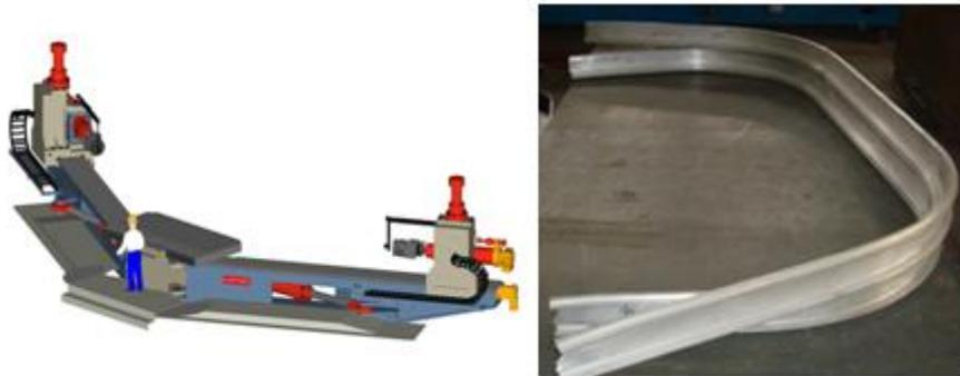
图 16-4 拉弯成型零件示意
