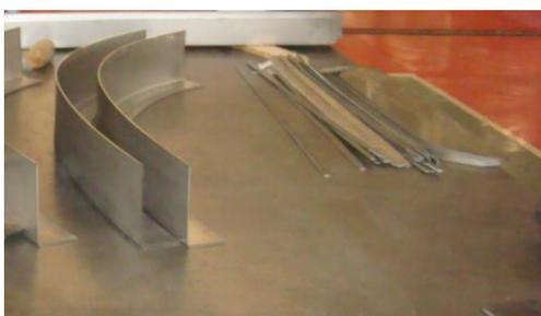
图 16-10 振锤成型典型零件
